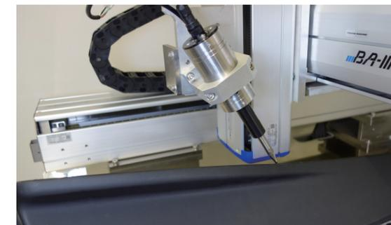
自動機による切断の様子
